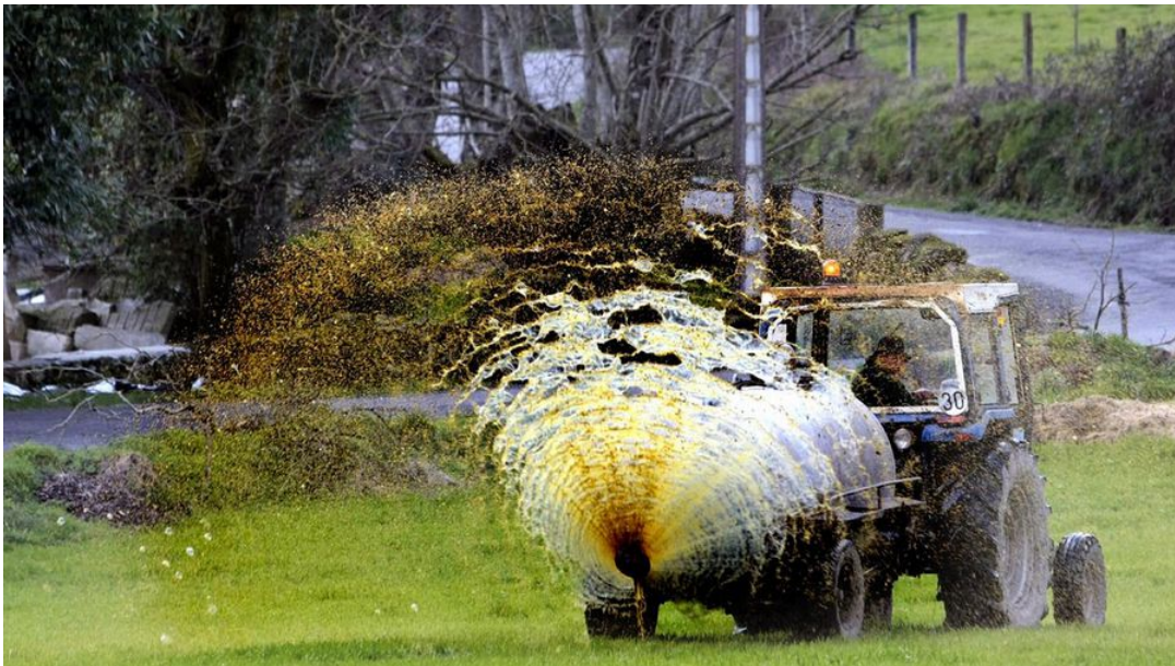
Foto 1. Cisterna de purín con sistema de aspersión con plato en Galicia 3 .
