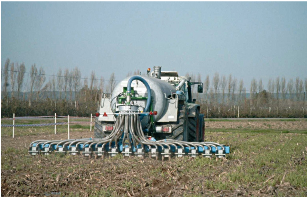
Foto 2. Cisterna de purín con sistema de inyección por tubos en Cataluña 4 .
